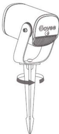
**Nota:** Se tenciona instalar este produto em solo muito duro, adquira à parte parafusos de expansão (expansion bolts) ou estacas metálicas.
