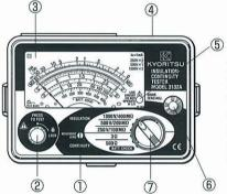
**①METER MOVEMENT ZERO ADJUST 2TEST BUTTON 3SCALE PLATE 4)INPUT CONNECTOR** (5) IVE CIRCUIT LAMP **®OHMS ZERO ADJUST PRANGE SELECTOR SWITCH**
