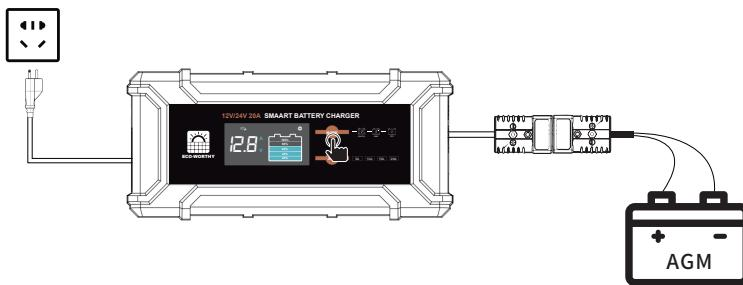
4. Nachdem Sie das Ladegerät an die Batterie angeschlossen haben, können Sie den Stromschalter anklicken, um den Strom einzustellen.
