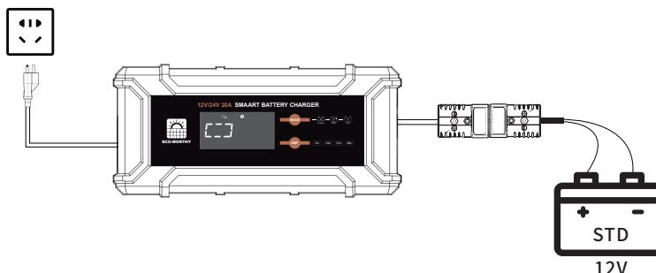
8. Niedrig-Temperatur-Ladmodus: Wählen Sie den Niedrigtemperatur-Ladmodus und schließen Sie das Ladegerät an den Akku an. Das Ladegerät lädt die Batterie mit einem geringen Strom (2A für 5 Minuten) und schaltet dann auf den normalen Ladestrom um. Dieser Modus ist nur für 12V/24V Blei-Säure-Batterien (STD, AGM) geeignet.
