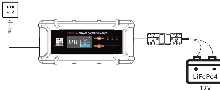
3. AGM-Modus: Nach Auswahl des AGM-Batterielademodus und des Ladestroms können Sie den Ladevorgang starten, indem Sie das Ladegerät an die Batterie anschließen (die Batteriespannung wird automatisch erkannt). Sobald die Batterie angeschlossen ist, ist es nicht möglich, den Batterietyp zu wechseln, aber es ist möglich, den Ladestrom zu ändern (12V: 5/10/15/20A; 24V: 5/10A).
