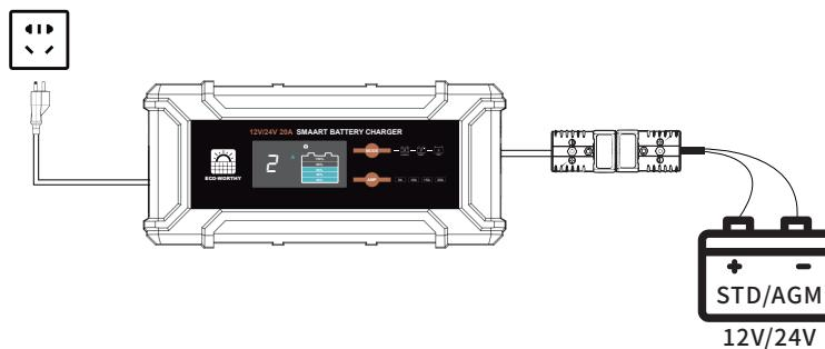
9. Lithium-Batterie-Aktivierungsmodus: Nachdem Sie den LFP-Modus ausgewählt haben, schließen Sie die Lithiumbatterie, die aktiviert werden muss, an das Ladegerät an, um den Aktivierungsprozess automatisch zu starten, der standardmäßig auf den 12-V-Aktivierungsmodus eingestellt ist. Halten Sie im LFP-Modus 3 Sekunden lang gedrückt, um in den 24-V-Aktivierungsmodus zu wechseln.
