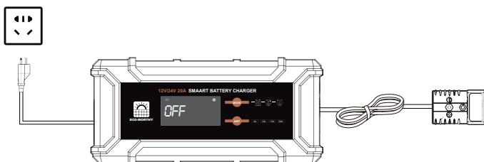
2. LFP-Modus: Nach der Auswahl des Lademodus und des Ladestroms für Lithium-Eisenphosphat-Batterien (LFP) schließen Sie das Ladegerät einfach an die Batterie an, um den Ladevorgang zu starten (die Batteriespannung wird automatisch erkannt). Sobald die Batterie angeschlossen ist, ist es nicht möglich, den Batterietyp zu wechseln, aber der Ladestrom kann geändert werden (12V: 5/10/15/20A; 24V: 5/10A).
