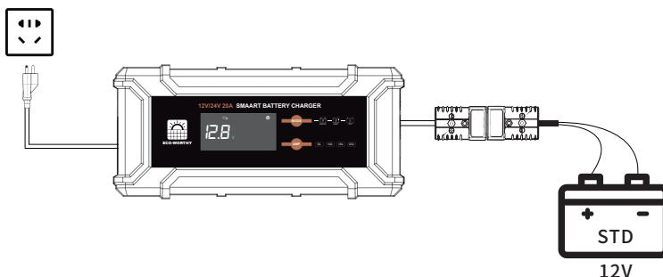
5. DC-Modus: Wählen Sie den Gleichstromversorgungsmodus, um das Ladegerät zur Stromversorgung an eine Gleichstromlast anzuschließen (Standardeinstellung ist 12V 20A). Halten Sie die Modustaste 3 Sekunden lang gedrückt, um auf 24V 10A DC umzuschalten. Nach dem Anschließen einer Batterie ist es nicht möglich, den Modus zu wechseln (der Strom im DC-Modus ist auf den Standardwert eingestellt und kann nicht geändert werden).
