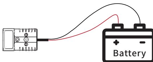
3. Nachdem Sie den entsprechenden Lademodus ausgewählt haben, schließen Sie das Ladegerät an die Batterie an. Wenn der Bildschirm die Batteriespannung und den Eingangsstrom anzeigt, bedeutet dies, dass der Ladevorgang läuft.
