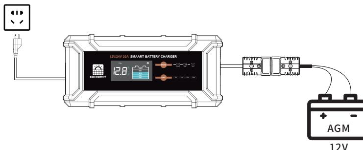
4. STD-Modus: Nachdem Sie den STD-Ladmodus und den Ladestrom ausgewählt haben, können Sie den Ladevorgang starten, indem Sie das Ladegerät an die Batterie anschließen (die Batteriespannung wird automatisch erkannt). Sobald die Batterie angeschlossen ist, ist es nicht möglich, den Batterietyp zu wechseln, aber es ist möglich, den Ladestrom zu ändern (12V: 5/10/15/20A; 24V: 5/10A).
