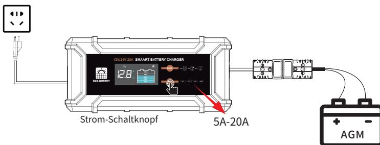
5. Ziehen Sie zuerst den Netzstecker, dann den Anderson-Stecker und schließlich die mit der Batterie verbundenen Kabel ab.
