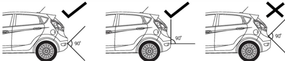
Distâncias recomendadas para instalar o sensor de estacionamento com 2 ou 4 sensores.
