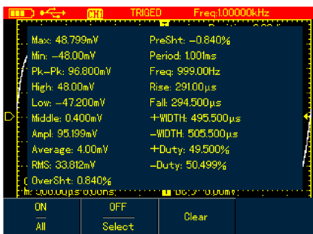
Figura 6-16 A - UTD1000CL medição de todos os parâmetros
