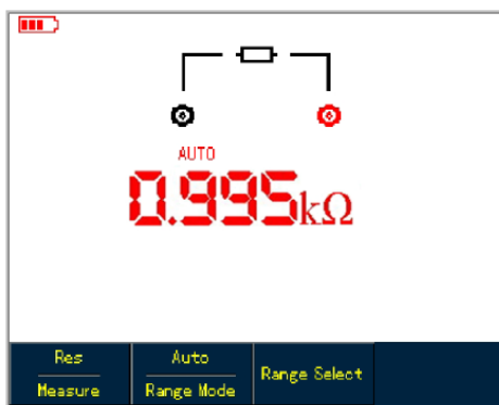
Figura 5-1 Medição da resistência
