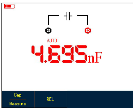
Figura 5-4 Medição de capacitância
