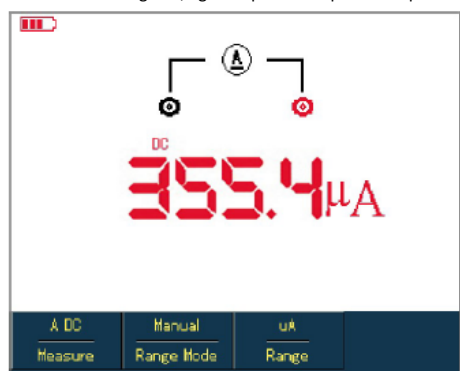
Figura 5-7 Medição de corrente DC inferior a 4 mA
