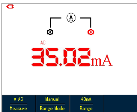
Figura 5-18 Medição de corrente AC inferior a 40mA
