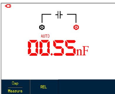
Figura 5-22 Medição da Capacitância em Modo Relativo
