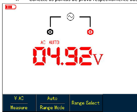
Figura 5-6 Medição da tensão AC
