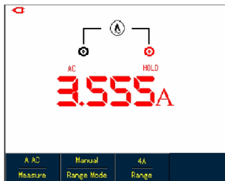
Figura 5-21 Retenção de valores de medição
