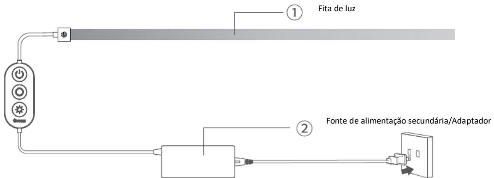
Para mover ou guardar mais facilmente esta fita de luz, a fonte de luz (1) pode ser desconectada do adaptador (2). Além disso, o adaptador e o cabo da ficha de alimentação podem ser desconectados entre si.
