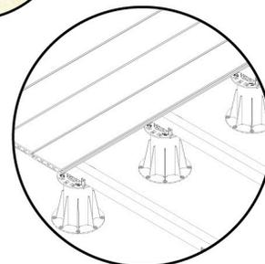
4.- Repetir los pasos anteriores, hasta finalizar la instalación completa del deck.
