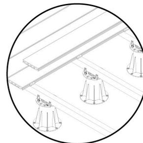
2.- Ajustar cada una de las fijaciones con el tornillo bien sea para estructura metálica o de madera, sin atornillar por completo la pieza. Importante en este paso utilizar la PUNTA ESTRELLA T15 X 50 mm para no estropear las tablas.
