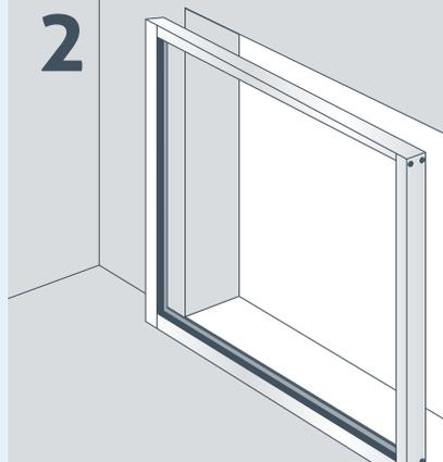
Presentar el marco en el vano, nivelar perfectamente y perforar según el esquema. Para las perforaciones del marco de aluminio utilizar broca de 4,5 mm y para perforar el vano utilizar una broca de 6mm.
