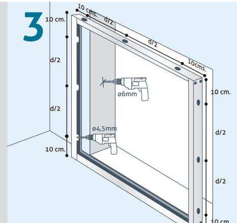
COLOQUE EL MARCO: Márquelo previamente y perfórelo utilizando broca de 4,5mm, según esquema. Para perforar el vano utilice broca de concreto de 6mm. El marco debe entrar libremente.
