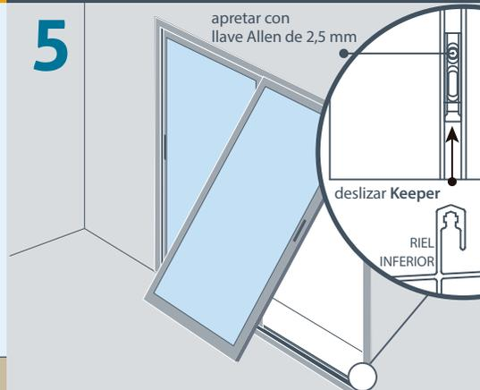
Montar desde el interior de la habitación, la hoja exterior (hoja con patines en parte inferior y cerradura en el lado izquierdo) luego la hoja derecha, terminado esto, liberar **Keeper** con llave allen y deslizarlo por el interior de la jamba (marco) hasta enganchar con enganche de cierre.
