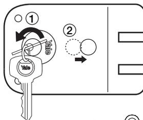
Para volver a función normal solo se debe mover la perilla en sentido que muestra la imagen.
