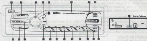
1. Botón de panel desmontado - Presione para sacar el panel desmontable.
