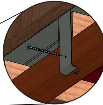
Doblar las pletinas de sujeción, para atornillarlas a la cercha y el listón vertical por el interior de la edificación. No se debe perforar el cerco para anclar la escotilla.
