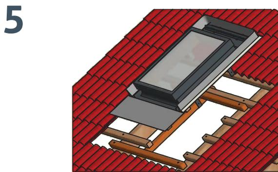
Construido el rasgo, se monta la escotilla pasándola hacia afuera de forma diagonal, tratando de no doblar el cerco.
