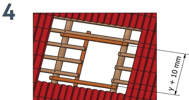
Construya el rasgo o vano agregando otro listón horizontal en la zona superior considerando la altura del marco de madera  $[y]$  de la escotilla más 10 mm. Además se debe agregar un listón vertical como se muestra en la ilustración.
