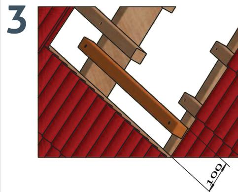
Agregue un listón en la zona inferior considerando una distancia de 100 mm hasta la techumbre. Debe quedar nivelado.
