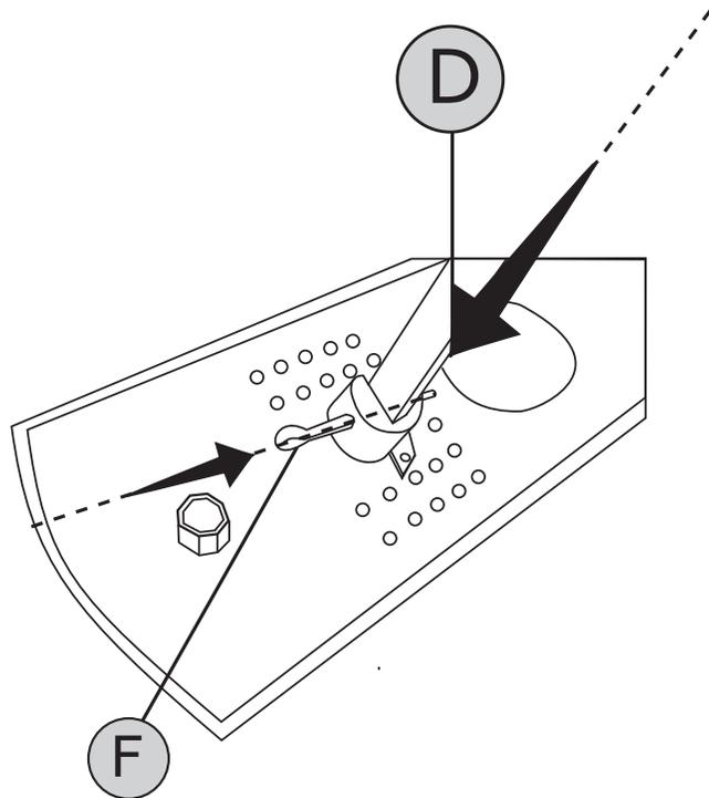
**Segundo:** Insertar la pieza D y luego pase el pasador F finalmente doble las patas para fijar
