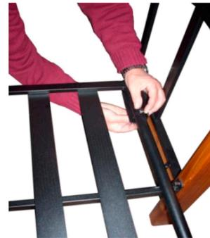
3. Luego coloque la parrilla del respaldo y haga coincidir las perforaciones con las del mecanismo colocando los pernos restantes de  $\frac{1}{4}$  x  $1 \frac{1}{2}$ . ver Figura 5 y 6.
