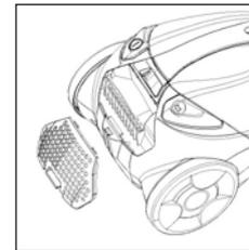
3. Puede seguir los pasos 4, 5 y 6 mencionados en el ítem "Limpieza del filtro del motor" o cambiar el filtro por uno nuevo.
