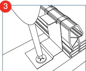
Fijar el anclaje T6 a la costanera (2 tornillos por fijación).
