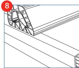
Instalar el Perfil UP en el inferior de la plancha.
