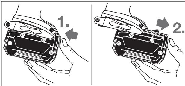
Para la extracción del acumulador (3), presione la tecla de desenclavamiento (4) y tire hacia delante el acumulador de la herramienta eléctrica. **No proceda con brusquedad.**
