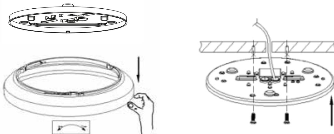
3. Conecte los cables de alimentación al bloque de terminales.
