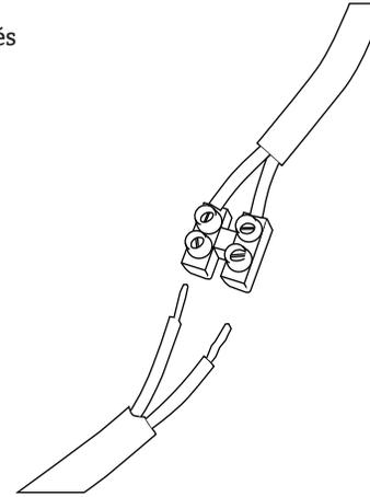
Posiciona y ajusta el cobre conexión y asegúralo con el prensacables.
