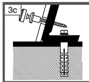
Ubique la taza en el piso, haciendo coincidir las perforaciones con los soportes (A) y coloque los casquillos (F) los tornillos (E) y fijelos atornillándolos.
