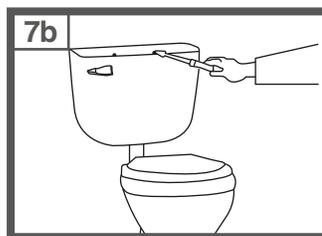
Coloque el tanque en la pared, haciendo coincidir las perforaciones de anclaje del tanque con los tarugos, instale los pernos, fije y nivele el tanque. Conecte el codo o bajada a la taza, fije y verifique que no existan filtraciones.
