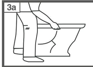
Coloque el inodoro en el piso, haciendo coincidir el orificio de salida con el desagüe y las perforaciones de anclaje con los tarugos.
