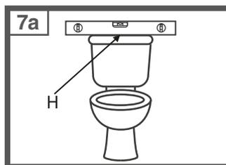
Fije y nivele el tanque, apretando alternadamente los pernos y tuercas. Evite sobreapriete.
