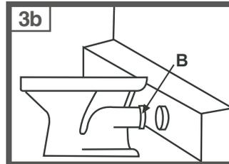
Instale el adaptador de goma en el conducto de salida y únalo al tubo de salida en el muro o zócalo.
