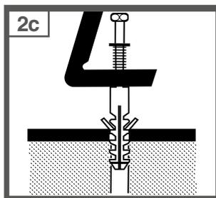
Instale los tarugos (B), soportes (A), tornillos (C), arandelas (D) y fijelos.
