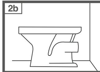
Coloque el inodoro en el piso, haciendo coincidir las perforaciones de anclaje con los tarugos.
