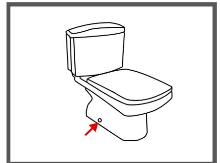
Coloque la taza en el piso, haciendo coincidir el orificio de salida con el desagüe. Marque el contorno y los ejes de las perforaciones de anclaje de la taza en el piso.
