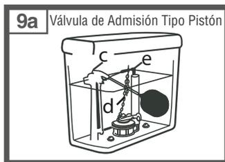
Para una máxima eficiencia ajuste el nivel del agua usando el tornillo ajustador (c). Coloque el tirante o cadena (d) en el brazo de la manilla o botón. Inserte la manguera de relleno (e) en el tubo de rebalse. Verifique que el flotador no tope con las paredes interiores.
