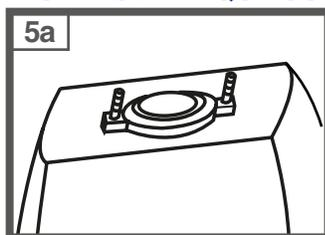
Instale el fitting y la goma sello en el tanque según las instrucciones.
