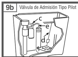
Para una máxima eficiencia ajuste el nivel del agua usando el tornillo ajustador (c). Coloque el tirante o cadena (d) en el brazo de la manilla o botón. Inserte la manguera de relleno (e) en el tubo de rebalse.
