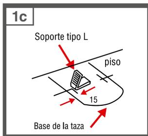
Retirar la taza y presente los soportes tipo L desplazando 15 mm hacia el interior de la base de la taza, marcar en el piso la ubicación de las perforaciones del soporte y perforo con broca de 10 mm a una profundidad de 60 mm.
