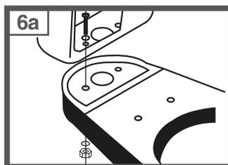
Coloque el tanque sobre el inodoro e instale los pernos, arandelas y tuercas.
