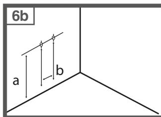
Marque la ubicación de las perforaciones de anclaje en el muro a la altura (a) y distancia (b) que corresponda, e inserte los tarugos plásticos (no suministrados).
