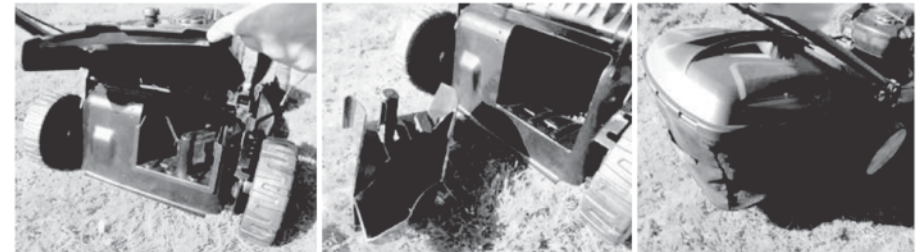
Instalación del recolector de pasto
