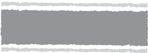
PATRÓN DE PULVERIZACIÓN DEFICIENTE (RESIDUOS)
