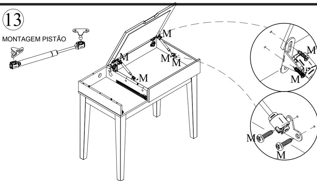
USANDO 2 CONJUNTOS M (2PISTÕES+8PARAFUSOS)
