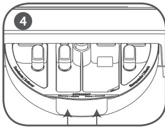
Los compartimentos para detergente se encuentran ubicados al medio del dispensador (Líquido y polvo). Después de aplicar el detergente debe girar el dispensador en 180° para cerrar.
