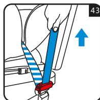
Tire de la correa diagonal fuertemente para apretar (mantener la tensión) y sujete la silla de seguridad con el cinturón diagonal lo más cerca posible de la hebilla del cinturón de seguridad del vehículo. (fig.43)
