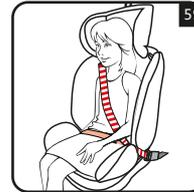
Coloque el cinturón diagonal y el cinturón de regazo en el lado de la hebilla del cinturón de seguridad del vehículo en la guía del cinturón inferior. (fig.59)
