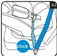
Pase el cinturón de regazo del vehículo a través de las dos guías del cinturón inferior, enganche el conector en la hebilla del cinturón de seguridad del vehículo. (fig.42) Vuelva a colocar el cojín infantil.
