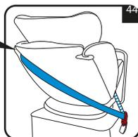
Guíe el cinturón diagonal alrededor del respaldo del asiento y luego a través de la guía del cinturón superior que está en el mismo lado del retractor del cinturón de seguridad del vehículo. (fig.44)
