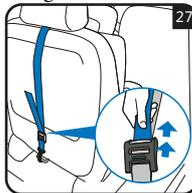
Para tensar la correa superior, elimine cualquier holgura tirando del extremo libre de la correa hasta que esté adecuadamente apretada. La correa se ajustará correctamente cuando el indicador de tensión se vuelva completamente verde. (fig.27)
