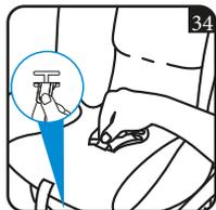
Sujete la placa metálica por debajo y gírela en posición vertical. Empuje hacia arriba y deslice la placa metálica a través de la ranura. (fig.34)
