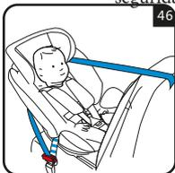
Haga que su hijo se siente en el asiento de seguridad. Ajuste el apoyo de cabeza a la altura adecuada (ver sección 4.3), ajuste el arnés y coloque la hebilla (consulte la sección 4.1) y apriete el arnés. (ver sección 4.2) (fig.46)
