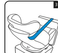
Guía de amarre superior a lo largo de ambos lados, luego fije el gancho de sujeción superior al punto de anclaje. (ver sección 4.7) (fig.39)
