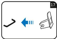
Si su vehículo no está equipado con las guías de inserción ISOFIX como estándar, recorte las dos guías de inserción que se incluyen con el asiento. Inserte hacia arriba en los dos puntos de fijación ISOFIX de su vehículo.
