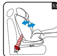
Tire de la correa diagonal fuertemente para apretar (mantener la tensión) y sujete la silla de seguridad con el cinturón diagonal lo más cerca posible de la hebilla del cinturón de seguridad del vehículo. (fig. 52)
