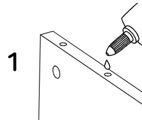
Antes de insertar cada tarugo, pon una gota de pegamento en la perforación.
