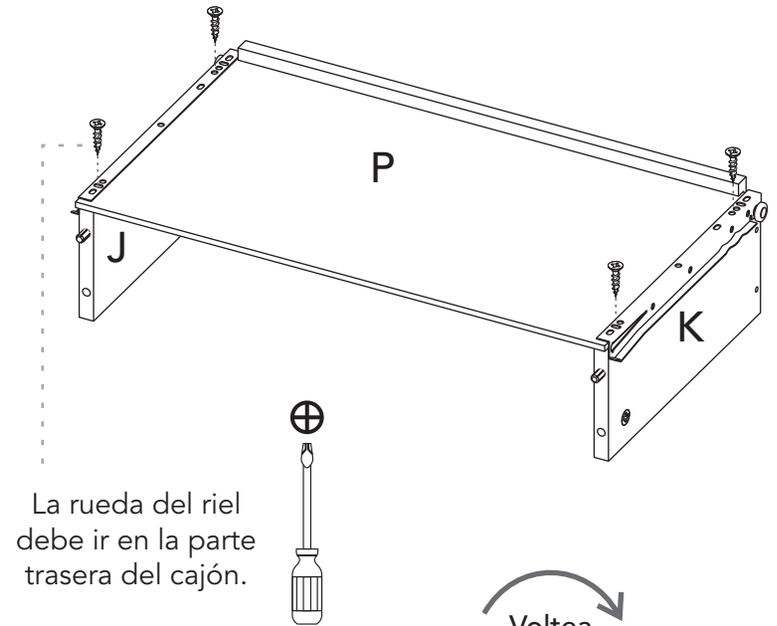
La rueda del riel debe ir en la parte trasera del cajón.
