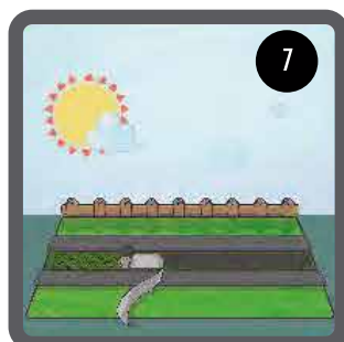
7 Doble los bordes cortados y ponga una cinta adhesiva por debajo / Dobre as bordas cortadas e aplique uma fita adesiva por baixo
