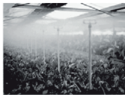
Sistema de riego tipo aereo
