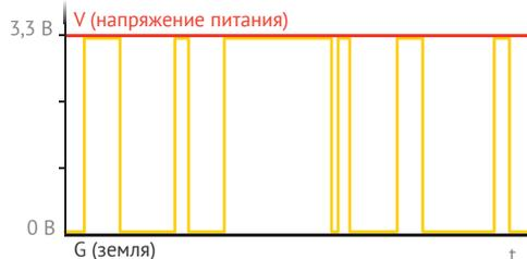
Здесь величина напряжения в любой момент времени равна либо 0 вольт, либо напряжению питания. А передаваемое значение определяется *последовательностью* и *длительностью* напряжений.
