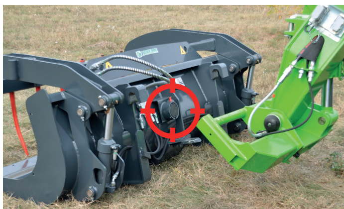
Sensor ubicado en el accesorio
