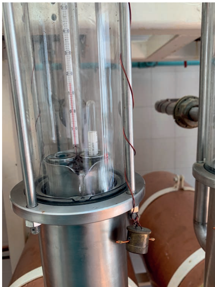
Alcolometro per misurare il grado alcolico del distillato in uscita
