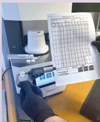
Calibrazione del forno con l'ausilio di un anello PTC, di un calibro digitale e di una tabella delle temperature
