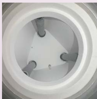
Elementi riscaldanti in disiliciuro di molibdeno (sopra) e in carburo di silicio (sotto). Gli elementi riscaldanti in carburo di silicio sono resistenti all'invecchiamento e quindi da preferirsi.
