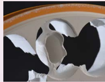
Restauro danneggiato durante l'estrazione dal fresatore.
