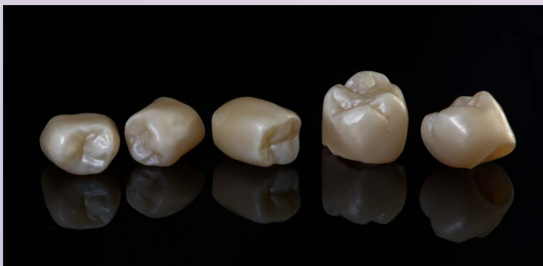
Corone in zirconia con opacità evidenti, in modo particolare nella zona dello smalto, tipicamente traslucente.
