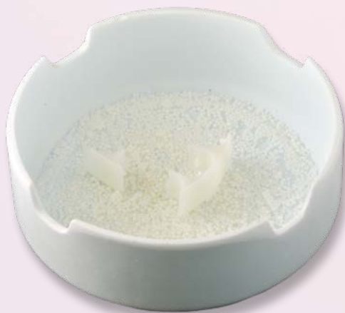
Residui di zirconia ad alta traslucenza bianca all'interno del vassoio su perle di sinterizzazione per la decontaminazione del forno.
