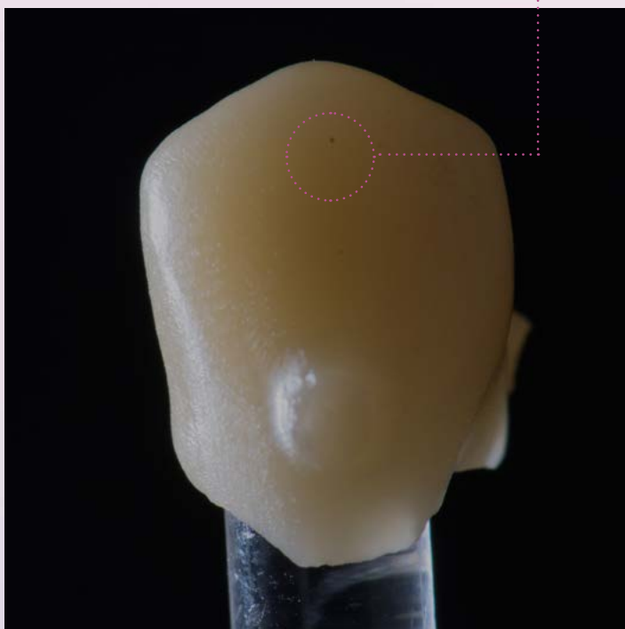
Macchie scure sulla superficie di un restauro dopo la fresatura, anch'esse attribuibili alla contaminazione.
