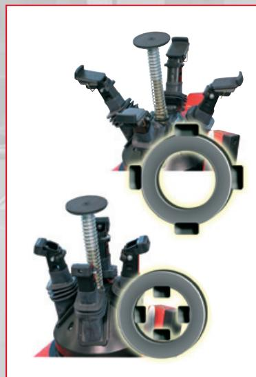
Sistema autocentrante di bloccaggio "a tulipano"
