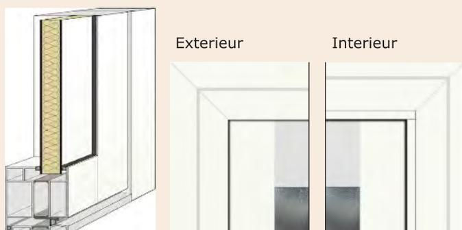
2.) **eFD „einseitig flügeldeckende“ Haustüren** mit einer Füllung **Kern F**, mit zusätzlicher Verankerung im Rahmen, auf Wunsch auch mit Stahleinlage für die Widerstandsklasse RC2 /RC3 geeignet lieferbar.
