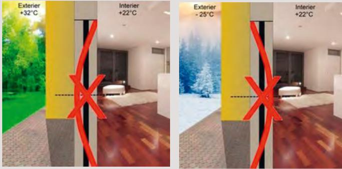
Durch die immer besser werdenden Wärmewerte der Haustüren kommt es zwangsläufig zu Vergrößerung der Unterschiede zwischen den Oberflächentemperaturen der Haustürfüllungen innen und außen. Gerade bei dunklen Farbtönen. Dies hat deren Deformation zur Folge – ein Bimetall-Effekt, der natürlich auch auf die Türprofile wirkt.
