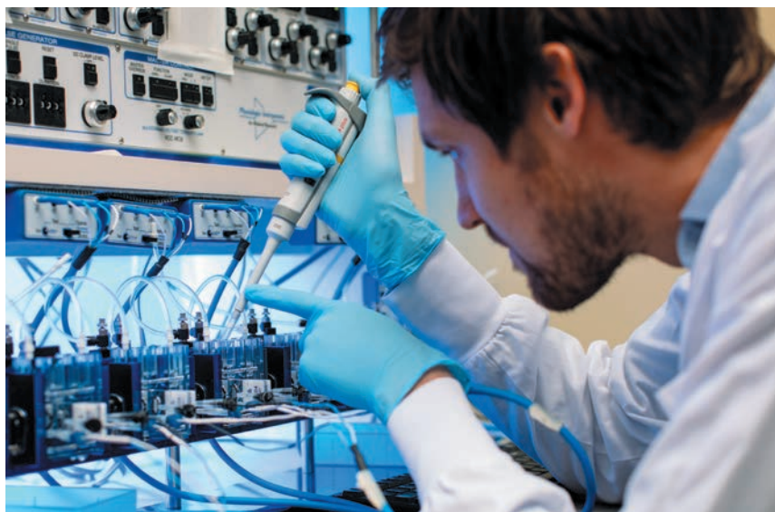
消化器系の生理機能に対する微生物およびその代謝物の影響を評価するチャンバー実験。
