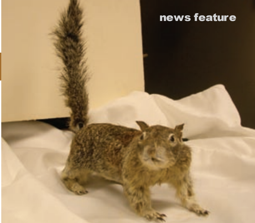
尻尾で威嚇：このジリスのロボットは、尾の温度を上げ、左右に振ることができる。このロボットを使って、リスがどうやって本物のガラガラヘビを追いかけるのかという仮説が検証されている。
