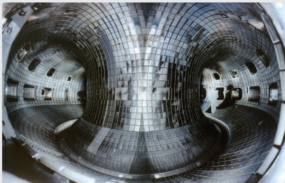
日本原子力研究所の大型トカマク実験装置「JT-60」の内部。ドーナツ状の空間部分にプラズマを閉じ込める。
