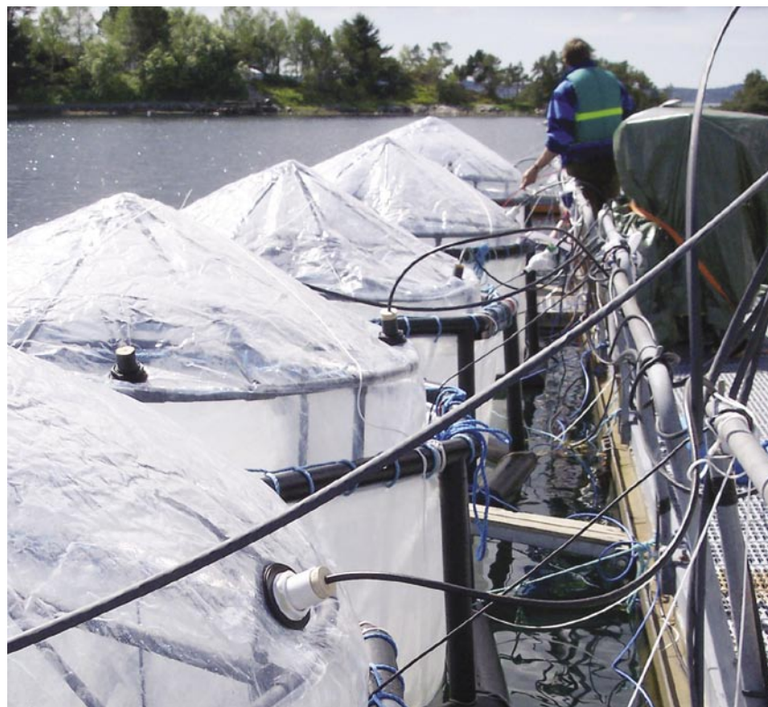
ノルウェー南西部のフィヨルドで酸性度を高めた海水を詰めたタンクを使って、低 pH が海洋生物に及ぼす作用が研究されている。
