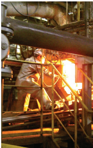
エコバレー歌志内では、一般廃棄物がプラズマトーチによってガス化され、蒸気タービンの動力となっている。
