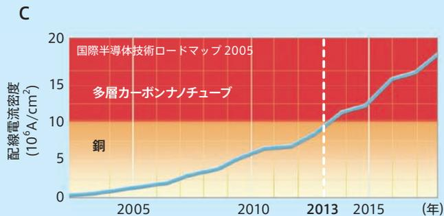
図4 LSIのビア配線と多層カーボンナノチューブ。Aは、LSIの構造を示す模式図。LSIは下から基板、トランジスタ層、配線層から成り立っている。横配線よりも切れやすい縦方向の配線（ビア配線）に多層ナノチューブを束にして使用する。Bは、シリコン基板上に成長させた多層ナノチューブの電子顕微鏡写真。孔の直径は2μm、この中におよそ1500本のナノチューブが成長している。Cは、微細化が進む半導体技術のロードマップで、製造年と配線に流れる電流密度の関係を示している。LSIの性能を上げるには電流をある程度たくさん流さなければならず、配線が微細化されるほど電流密度は上がっていく。2013年には、配線に流れる電流密度が銅の許容範囲を超えてしまう。
