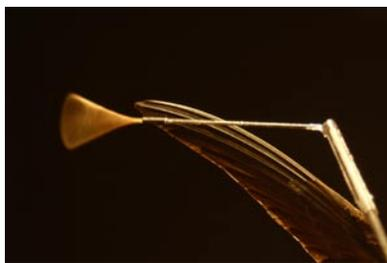
アマツバメの翼を使った風洞実験
