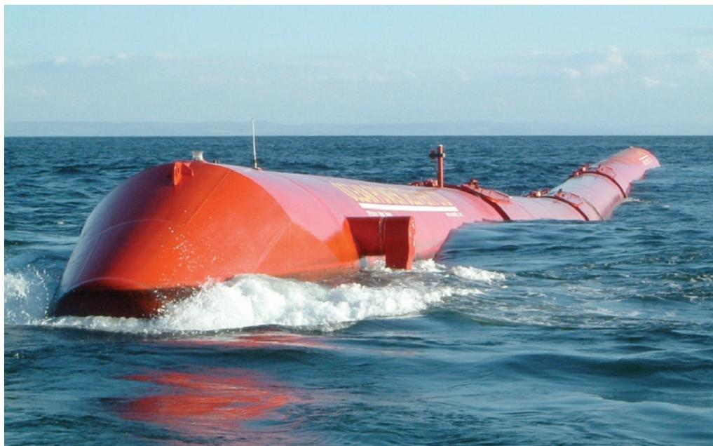
ウミヘビ：Pelamis社は、英国スコットランドのオークニー諸島で750キロワットの波力発電装置を試験してきた。
