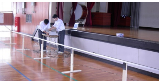
水平型の加速度認識装置。長さ 10m の装置に、20cm 間隔で LED が取り付けられている。
