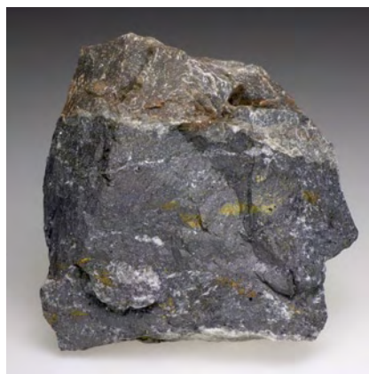
図2 左の写真の黒灰色部は熱水噴出孔(チムニー)の外側で閃亜鉛鉱から、白色部は硬石膏から成る。黄色色の部分はチムニーの内側で熱水の通路部に沈殿した黄銅鉱が光を反射して輝いている。右は黒鉱の写真で、最上部の赤色は赤鉄鉱(バンド主成分は重晶石)による着色。黒色部の主成分は閃亜鉛鉱と方鉛鉱、黄色部は黄銅鉱を主とし、白色部は重晶石。
