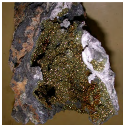
図2 左の写真の黒灰色部は熱水噴出孔(チムニー)の外側で閃亜鉛鉱から、白色部は硬石膏から成る。黄色色の部分はチムニーの内側で熱水の通路部に沈殿した黄銅鉱が光を反射して輝いている。右は黒鉱の写真で、最上部の赤色は赤鉄鉱(バンド主成分は重晶石)による着色。黒色部の主成分は閃亜鉛鉱と方鉛鉱、黄色部は黄銅鉱を主とし、白色部は重晶石。
