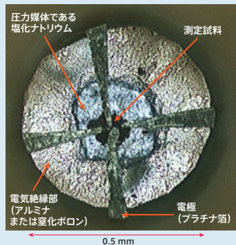
図 1 超高圧下で電気抵抗の有無を測定するダイヤモンドアンビルセルの断面写真。中央の超伝導物質の試料の周りに、圧力媒体の塩化ナトリウムを置き、4 つのプラチナ電極で電気抵抗を測定する。
