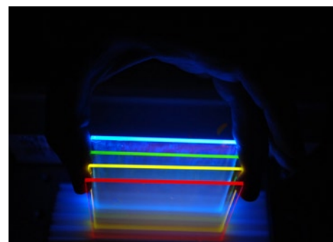
色素分子の混合物を含む薄膜で被覆したガラス板を重ねて使うことで、異なる波長の光を効率よく吸収できる。
