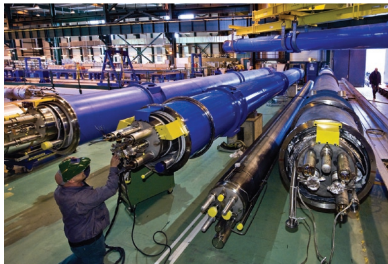
ヘリウム流出事故の後、LHC のトンネルから運び出されて修理中の双極子磁石。
