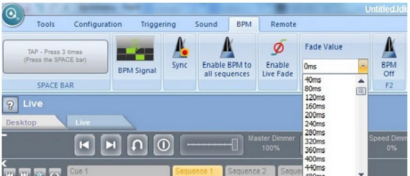
Por último, el BPM apagado elimina todos los disparos BPM de sus secuencias. En los ajustes de BPM le puede asignar la fuente del BPM.
