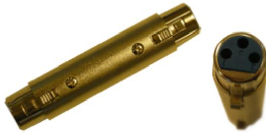
Conecta el convertidor al contacto macho (entrada DMX) de tu interfase.
