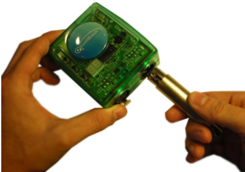
Conecta tu cable DMX al convertidor.
