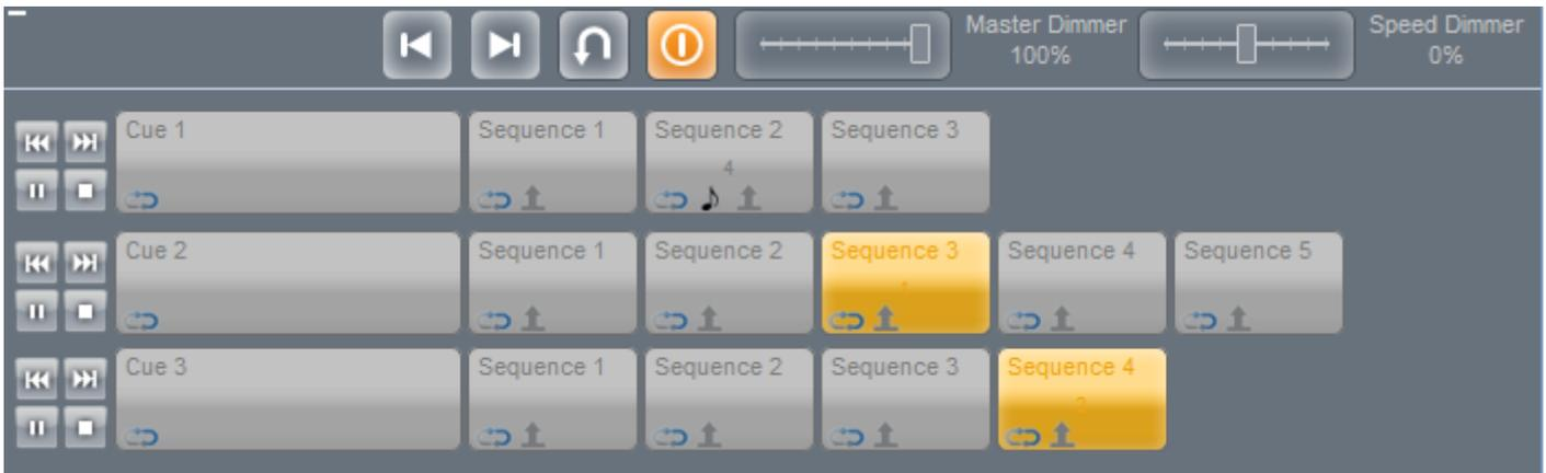
Para usar el "Master Dimmer", cambia la posición del deslizable. Para deshabilitar la función, haz clic derecho sobre el deslizable.
