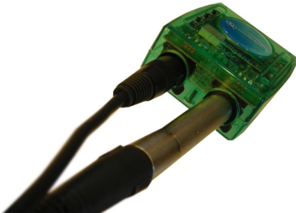
Ahora necesitamos configurar el software para cambiar la entrada DMX a una salida DMX. Verás que el display de tu interfase dice "PC", y que el segundo LED rojo (mostrado con la flecha) está apagado.
