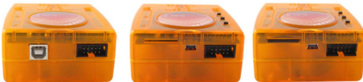
Il s'agit d'un connecteur électronique de type HE10. Vous pouvez y connecter un clavier avec 8 boutons par exemple. Il suffit pour cela d'établir un contact entre chacun des 8 ports et la masse.
