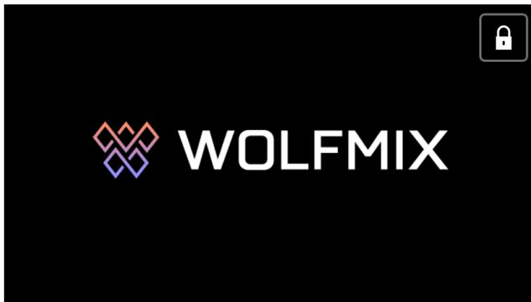
Wolfmix kann gegen unbefugten Zugriff gesperrt werden. Wenn Sie auf dem Einstellungsbildschirm auf *Lock All* tippen, wird der gesamte Controller gesperrt. Tippen Sie hingegen auf *Lock Edit*, wird nur die Paletten-, Preset- und Fixture-Bearbeitung gesperrt.
