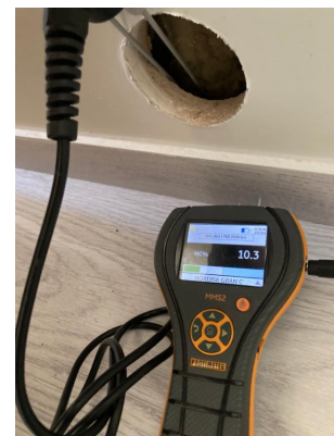
Fuktmåling 11.01.23 etter installasjon av dusjkabinett.
